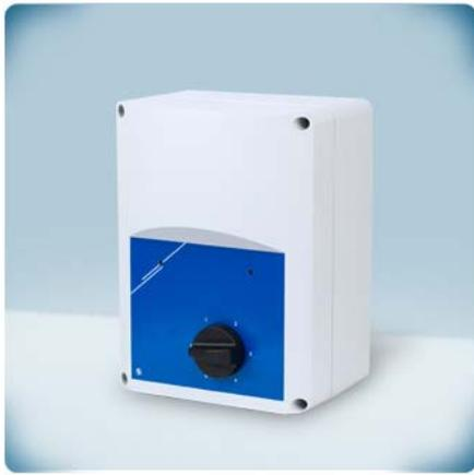
Die Traforegler ETA regeln die Drehzahl von einphasigen spannungsregelbaren Motoren durch Änderung der Ausgangsspannung. Sie sind ausgestattet mit einem Spartransformator und regeln manuell die Geschwindigkeit in 5 Schritten. Die benutzte Technologie gibt eine geregelte Ausgangsspannung mit einer perfekten Sinusform. AP-ABS Kunststoffgehäuse, Grau RAL 7035.
