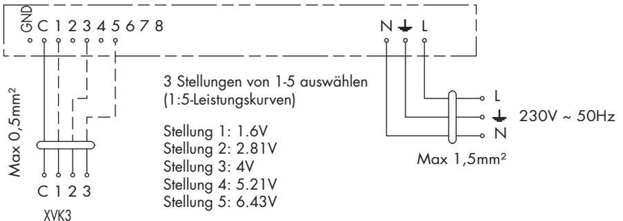
Prüfen, ob die gewünschte Fördermenge mit den ausgewählten Einstellungen gewährleistet ist. Bei Bedarf die Einstellung anpassen und eine schwächere/stärkere Druckkurve wählen.
